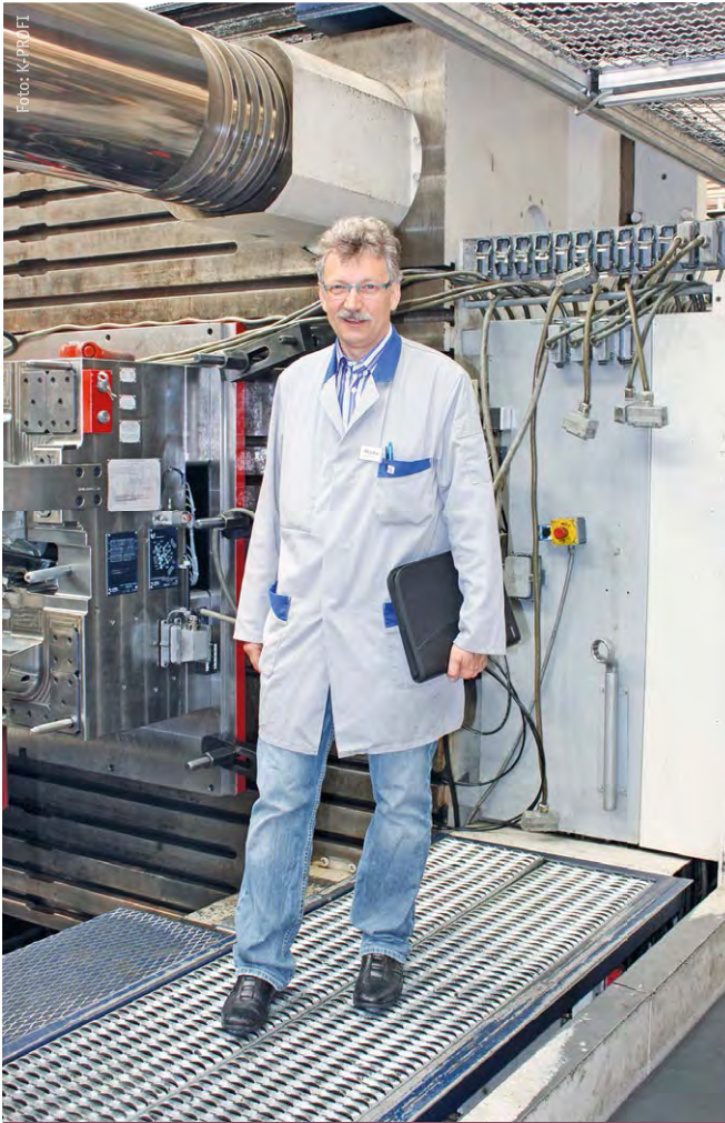
Jürgen Wabersich veranschaulicht die Größenordnung des Werkzeug-einbauraums der 54.000-kN-Spritzgießmaschine.
