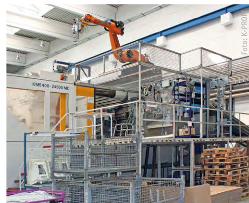
Gigantische Dimensionen: Auf der Maschine mit 54.000 kN Schließkraft können großflächige Bauteile mittels Kompakt- und Mucell-Spritzguss im direkten Vergleich gefertigt werden.
