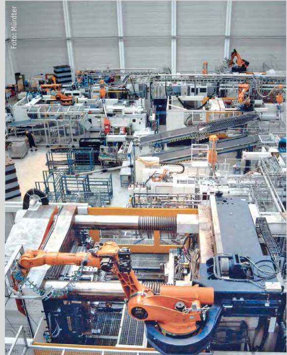
Im oberen Schließkraftbereich arbeitet Mürdter neben der 54.000-kN-Maschine zudem mit einer 27.000-kN-Maschine und zwei 23.000-kN-Maschinen.
