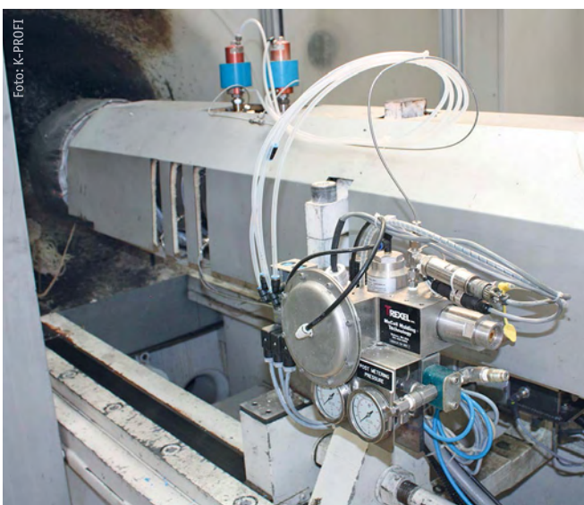
Mit dem auf der Plastifiziereinheit montierten SCF-Injektor wird Stickstoff direkt in die Kunststoffschmelze dosiert. Ein Drucksensor überwacht den Schmelzedruck zwischen den beiden Rückströmsperren der Schnecke.
