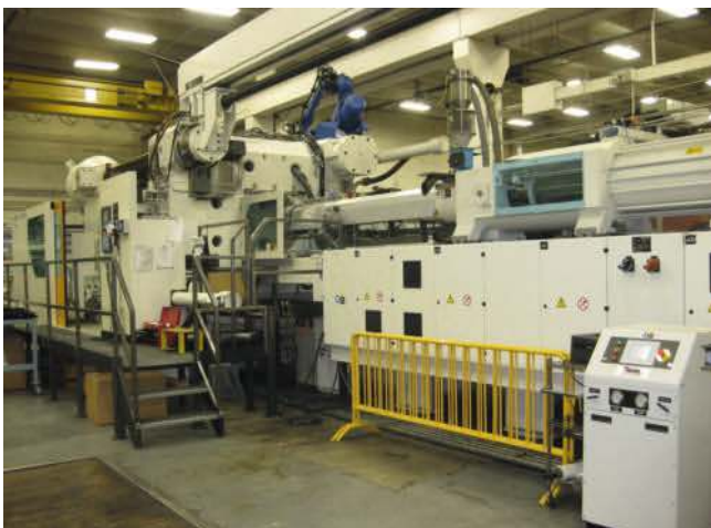
... und auch in den USA gibt es die Möglichkeit, „echte“ geschäumte Großbauteile zu mustern. Die MX 2700 mit MuCell-Equipment, die bei Proper Mold bereitsteht, hat allerdings nicht die beeindruckenden Dimensionen wie die Anlage bei Mürdter (oben)
