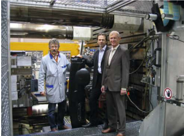
Bild 5. Jürgen Wabersich (Mürdter), Andreas Handschke (KraussMaffei) und Dr. Hartmut Traut (Trexel, v. l. n. r.) begutachten die größte MuCell-Spritzgießmaschine der Welt. Die MC 5400-17.200 mit 54 000 kN Schließkraft eignet sich für das Kompakt-Spritzgießen, das MuCell- sowie das SGI-Verfahren (siehe Infokasten) gleichermaßen, ...
