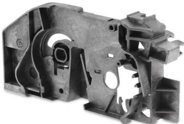
Bild 2. Durch das physikalische Schäumen kann dieses Türschlossgehäuse mit 30% weniger Schließkraft und 25% schneller (Zykluszeitverkürzung) hergestellt werden
