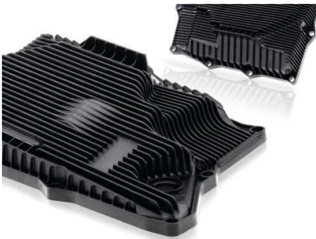
Bild 4. Die Ölwanne aus geschäumtem Kunststoff punkten gegenüber Metallölvannen mit ihrem erheblich geringeren Gewicht und ihrer Verzugsfreiheit, die eine problemlose Montage erlaubt
