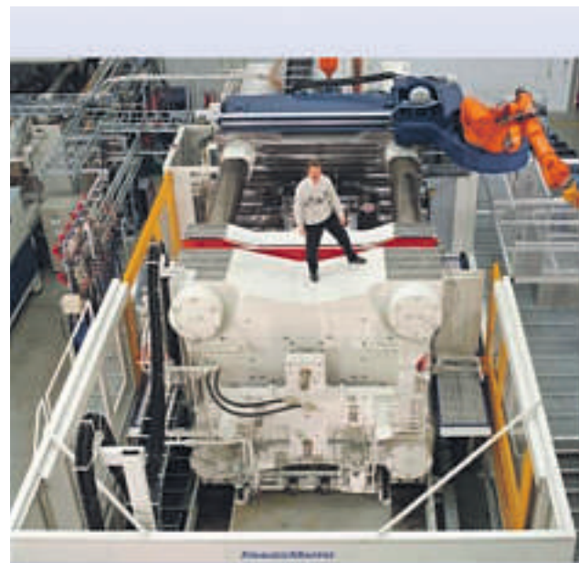
Gewaltige Dimensionen: Die weltgrößte Spritzgießmaschine im Technikum der Mürdter Gruppe in Mutlangen.
